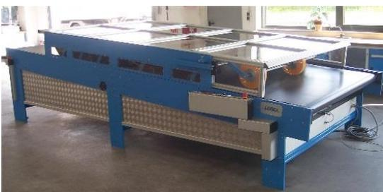
Das Schuppungsband presst die kaschierten Bogen leicht zusammen und fährt den Bogen durch eine 2 m lange Press-Strecke. Damit bindet der Leim die kaschierten Schichten zusammen.
