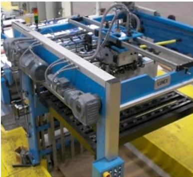
Der Anleger für den Druckbogen ist ein Stapelanleger mit Saugtrennkopf, von den Druckmaschinen bekannt.
